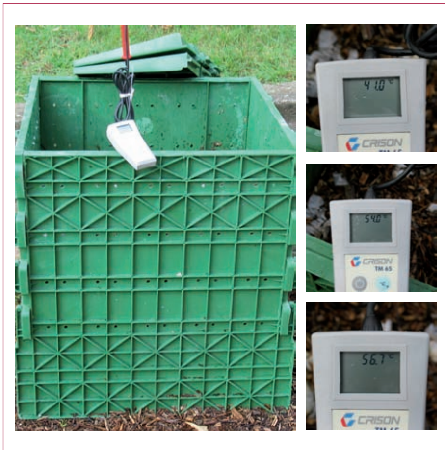
FIGURA 14. Compostador amb sonda de temperatura.
